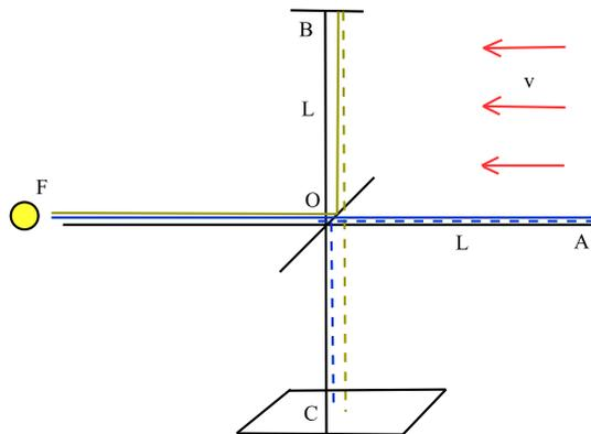
El experimento consistía en lo siguiente. En un dispositivo con dos brazos perpendiculares de longitud  $L$  se pone una fuente de luz monocromática a la izquierda, y un semiespejo en el origen  $O$  inclinado  $45^\circ$ . Se supone inicialmente que el éter se desplaza de derecha a izquierda paralelo al eje horizontal con velocidad  $v$ . Una parte de los rayos de luz siguen el trayecto desde la fuente
